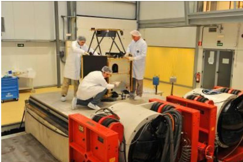
Ensayo de vibración en las instalaciones del INTA
